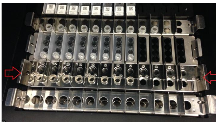
Figura 5-74: Retiro del rack de extracción
