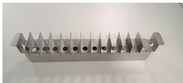
Figura 5-73. Gradilla para probetas de extracción
