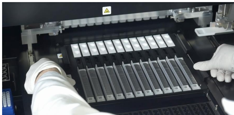
Figura 5-63: Carga del rack con los Contenedores de extracción.
