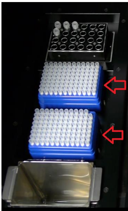
Figure 5-57 Mise en place des embouts dans l'instrument.
