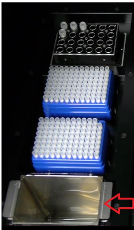
Figure 5-41: Emplacement du conteneur à déchets sur l'instrument.
