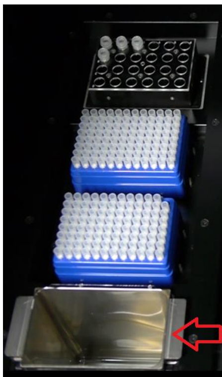
Figura 5-41: Posicionamento do recipiente para resíduos no instrumento.
