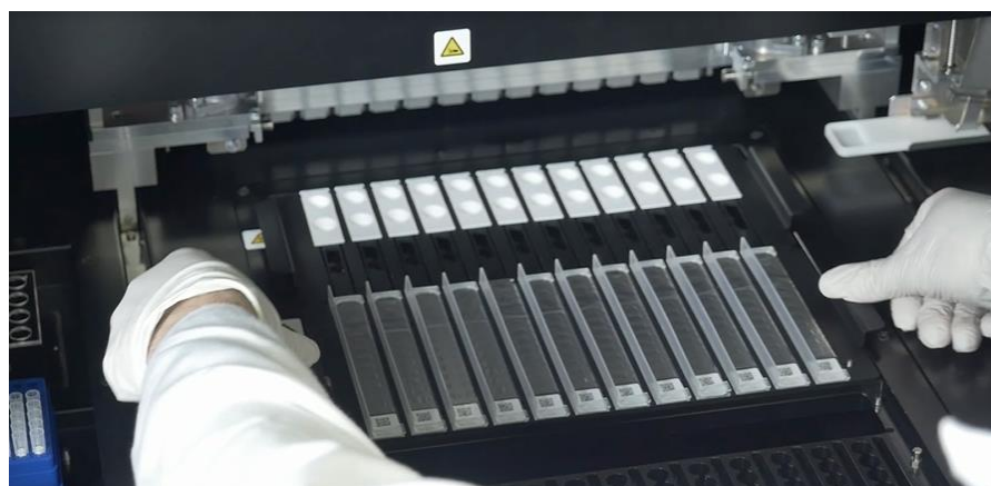
Figura 5-63: Carregamento do suporte das caixas de extração.
