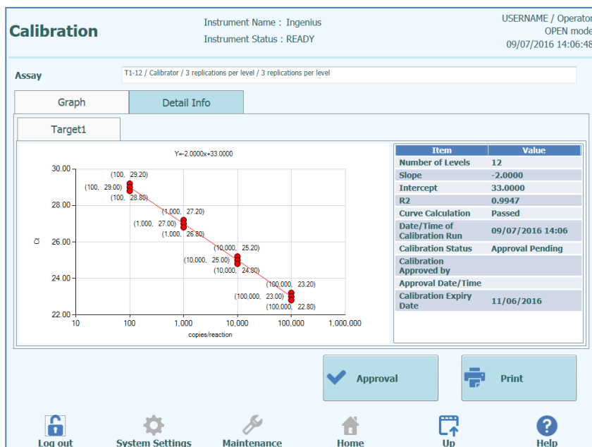
Figuras 5-112: Painel de calibração - Curva padrão e replicados
