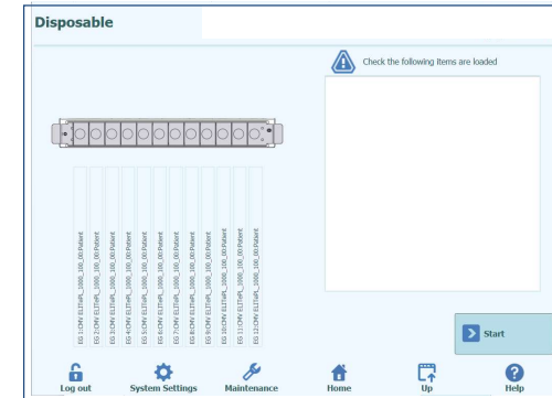
Figura 13. La pantalla «Disponible» (Desechable) se utiliza para confirmar la carga de rack de muestras.
