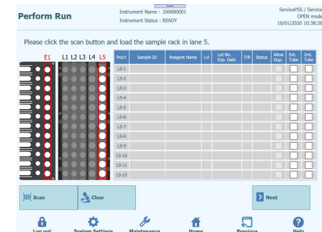
Figura 21: Inserção do suporte de configuração da execução
