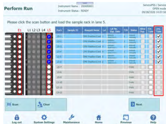
Abb. 5-157: Markieren der Spalte „2 mL Tube“ (2-ml-Röhrchen) bei einem 2-ml-Kontrollröhrchen
