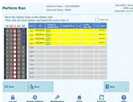
Abb. 5-98: Aktivieren des Barconde-Scans am L3-Elutionsrack
