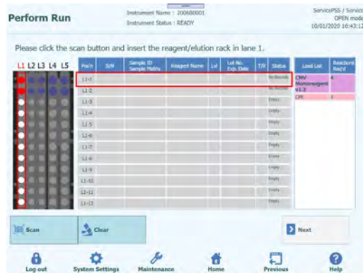
Abb. 5-141: Auswahl der Position der Kühleinheit, an der das Reagenz platziert ist
