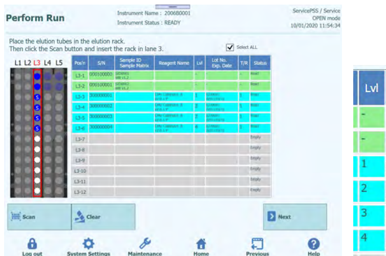
Abb. 5-107: Auswahl der Füllstände für das Kalibrierröhrchen
