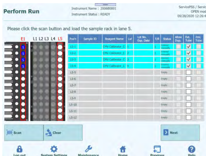
Abb. 5-160: Kontrolle des Extraktionsröhrchens, wenn Kalibratorreagenz in einem Extraktionsröhrchen ist
