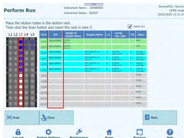
Abb. 5-115: Eingabe der Seriennummer für das Kalibratorreagenz-Röhrchen
