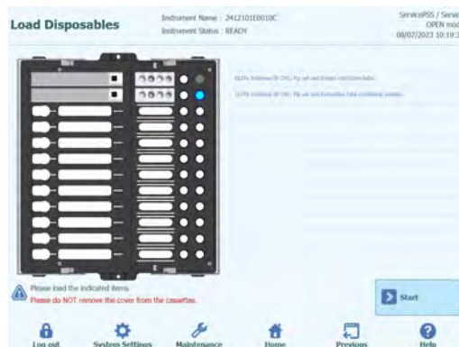
Abb. 5-185: Anzeige unterschiedlicher Farben für Extraktionsröhrchen: grau, wenn sie leer sind, hellblau, wenn sie eine Probe enthalten.
