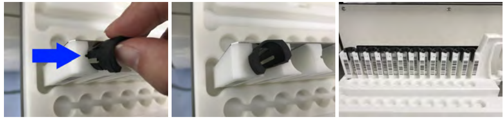
Abb. 4-5: Einsetzen von Probenrack-Adapttern in das ELITE BeGenius Rack.
