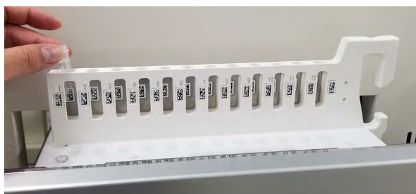
Abb. 5-128: Einsetzen eines leeres Eluatröhrchens in das Rack
