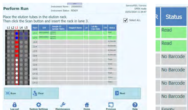
Abb. 5-110: Status „No Barcode“ (Kein Barcode), wenn kein Etikett am Kalibrierröhrchen angebracht ist
