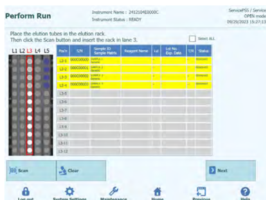
Abb. 5-116: Aktivieren des Barconde-Scans am L3-Elutionsrack
