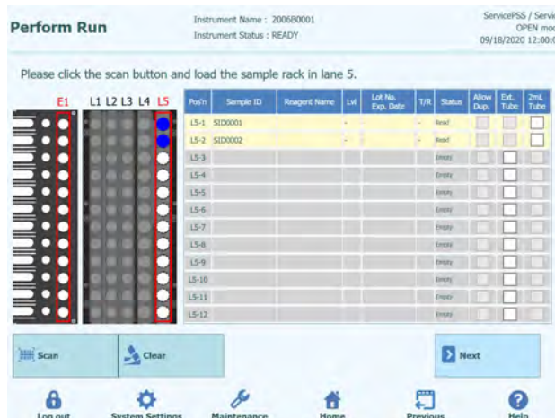
Abb. 5-36: Barcode-Scanergebnisse des Racks
