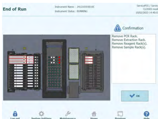
Abb. 5-211: Bildschirm „End of Run“ (Ende des Laufs) mit Anweisungen zur Entnahme, Aufbewahrung und Entsorgung der Proben, Materialien und Reagenzien
