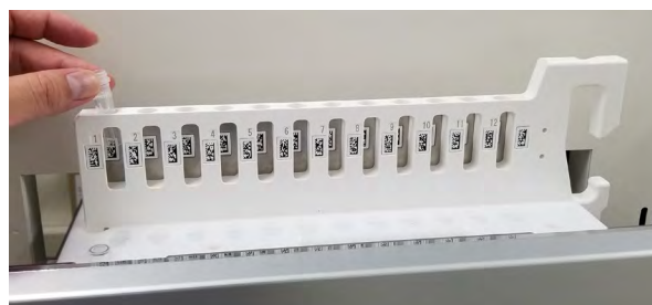
Abb. 5-135: Einsetzen eines Reagenzröhrchens in das Rack
