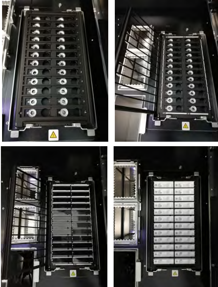
Abb. 5-177: Einsetzen von PCR-Kassetten auf das PCR-Rack des Geräts
