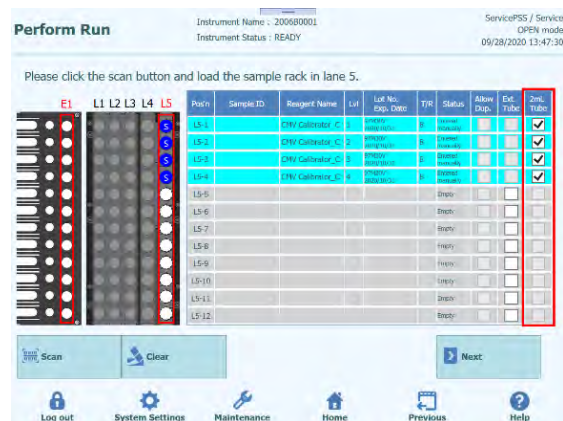
Abb. 5-156: Markieren der Spalte „2 mL Tube“ (2-ml-Röhrchen) bei einem 2-ml-Kalibrorröhrchen
