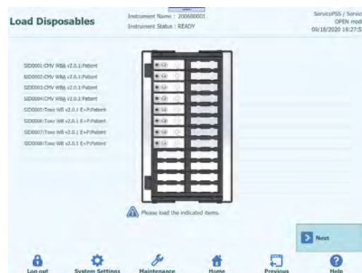
Abb. 5-176: Bildschirm für das Einsetzen der für den Lauf benötigten PCR-Kassetten
