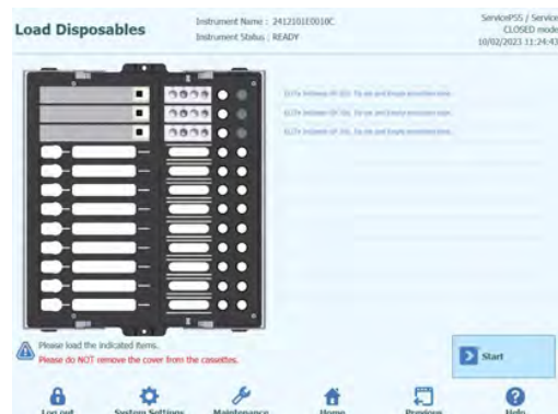
Abb. 5-184: Einsetzen der für die zweite Extraktion benötigten Extraktionskassetten, Spitzensets und Extraktionsröhrchen
