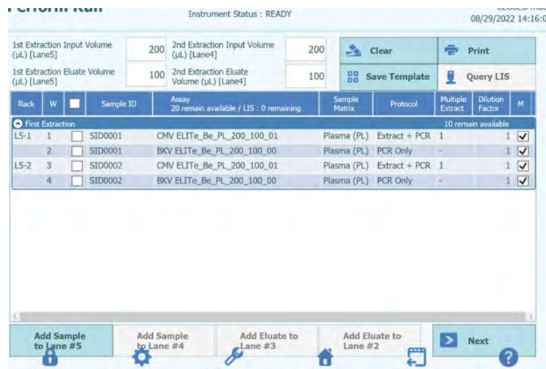
Abb. 5-56: Bildschirm der zugewiesenen Assay-Protokolle in der Spalte „W“ von Well 1 ausgehend
