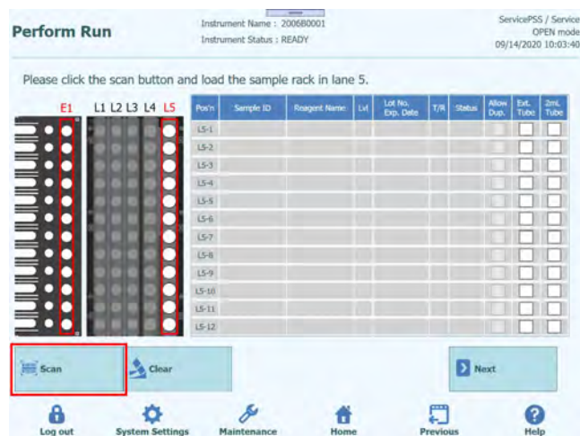
Abb. 5-35: Aktivierung des Barconde-Scans des L5-Probenracks
