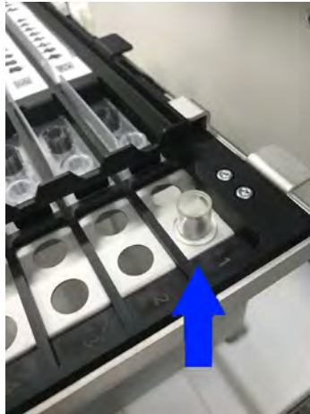
Abb. 5-48: Einsetzen von Extraktionsröhrchen in das Extraktionsrack
