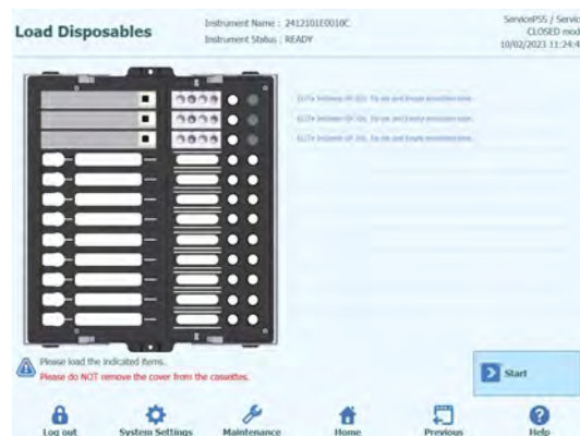
Abb. 5-178: Einsetzen der für den Lauf benötigten Extraktionskassetten, Spitzensets und Extraktionsröhrchen
