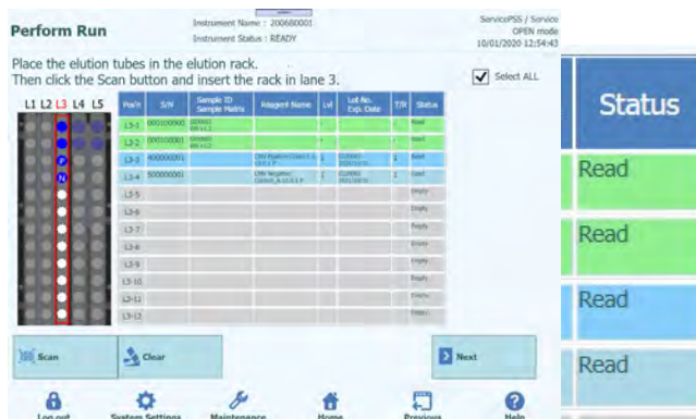
Figura 5-118. Estado «Read» (Leído) cuando la probeta del control se ha leído correctamente
