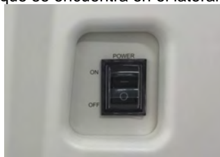
Figura 5-221. Interruptor principal de alimentación situado en la parte derecha del instrumento
