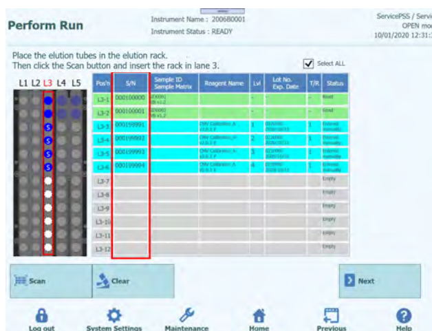
Figura 5-115. Introducción del número de serie de la probeta de reactivos del calibrador
