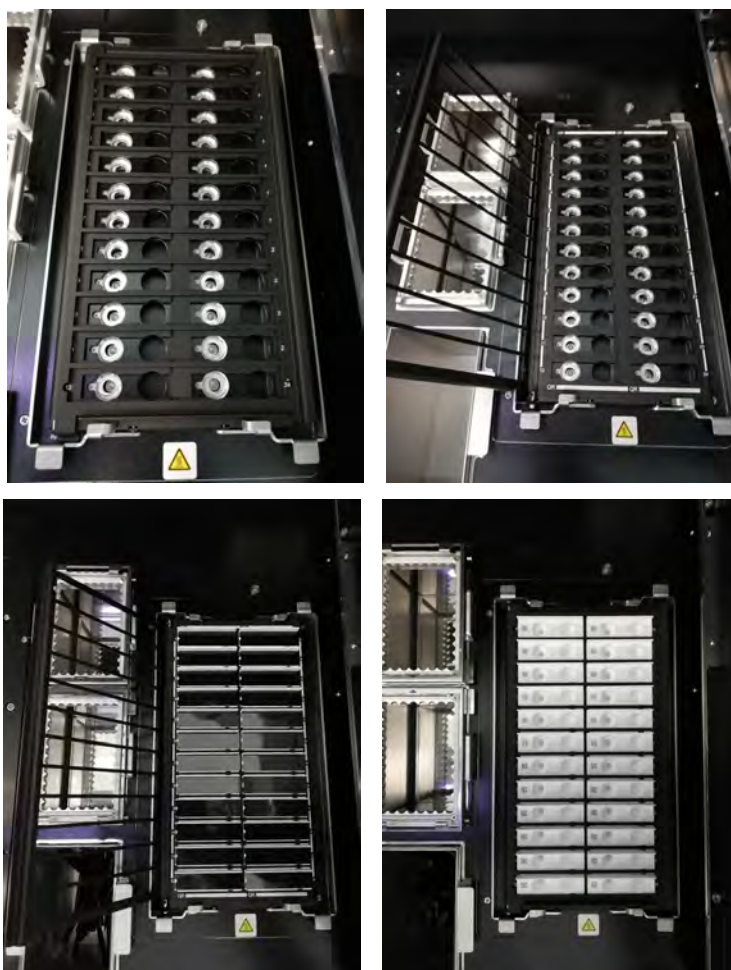
Figura 5-177. Colocación de los PCR Cassette en la gradilla de PCR del instrumento
