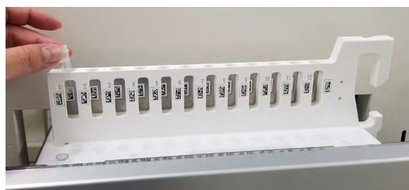
Figura 5-135. Inserción de la probeta de reactivos en la gradilla
