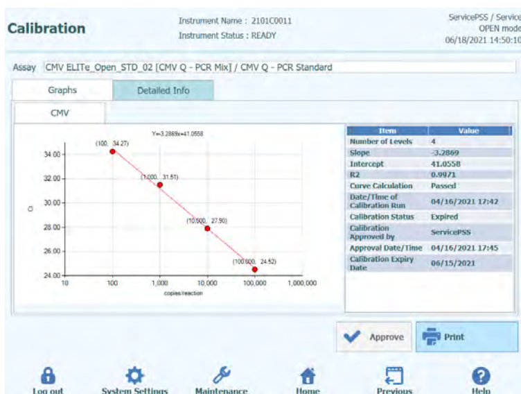
Figura 5-15. Curva de calibración de la ficha «Graph» (Gráfico)
