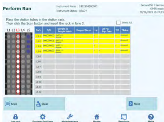
Figura 5-116. Activación del escaneado de los códigos de barras de la gradilla de elución del carril L3
