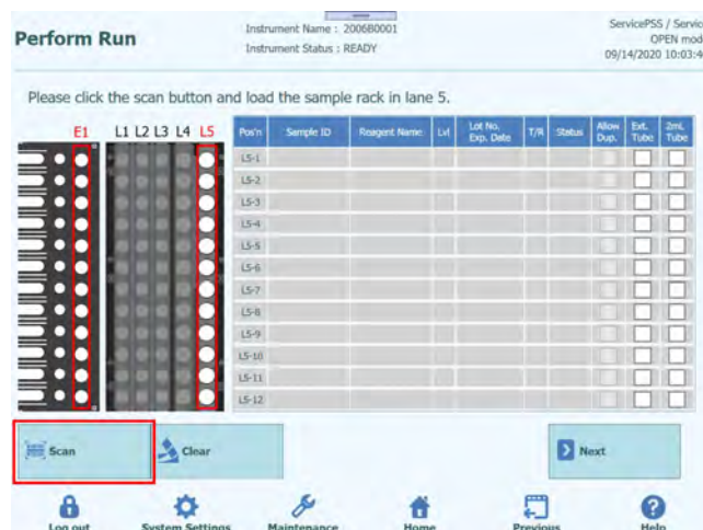
Figura 5-35. Activación del escaneo de los códigos de barras de la gradilla de muestras del carril L5
