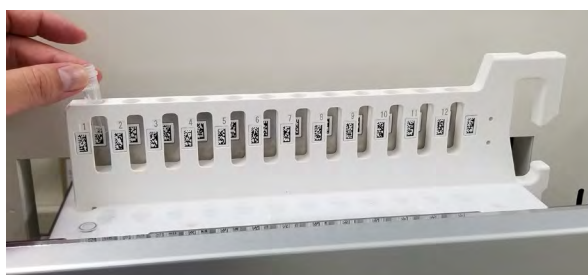
Figura 5-128. Inserción de la probeta de eluido en la gradilla
