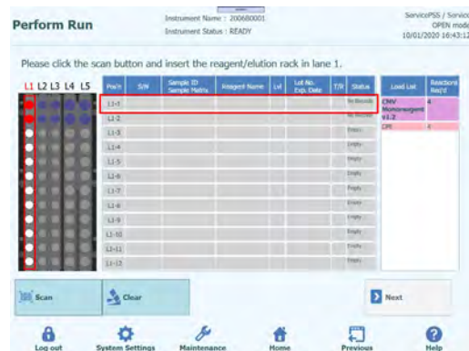
Figura 5-141. Selección de la posición de la «Cooler Unit» (unidad de refrigeración) en la que se ha colocado el reactivo
