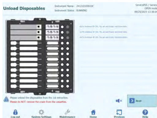
Figura 5-182. Distribución de los cartuchos de extracción, de los juegos de puntas y de las probetas de extracción utilizados en la primera extracción
