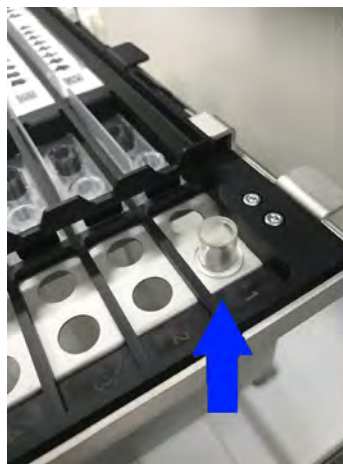
Figura 5-48. Colocación de la probeta de extracción en la gradilla de extracción
