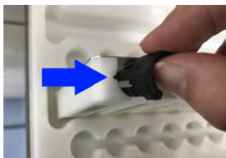
Figura 4-5: Inserimento degli adattatori nel rack ELITE BeGenius
