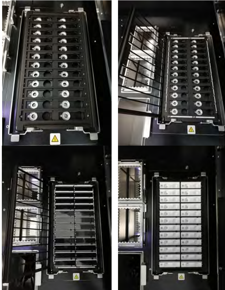
Figura 5-177: Installazione delle cassette di PCR nel rack di PCR
