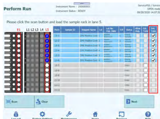
Figura 5-157: Selezione Tubo da 2 mL nel caso di tubo del controllo da 2mL
