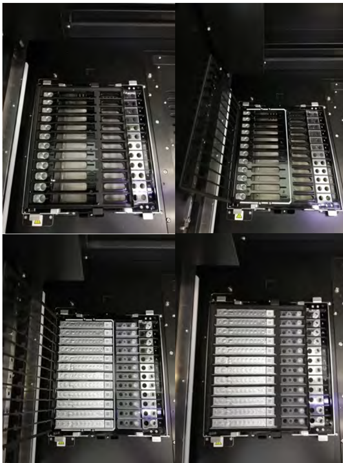
Figura 5-179: Installazione dei consumabili di estrazione nel rack dedicato all'estrazione
