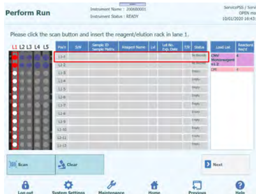
Figura 5-141: Selezione della posizione della cooling unit in cui è stato inserito il reagente
